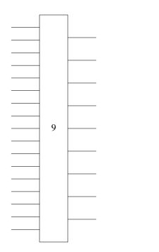
GATE TYPE 9. BLACK BOX INPUTS A1-8, B1-8. OUTPUT D1-8 = A1-8<sup>-</sup>B1=8
